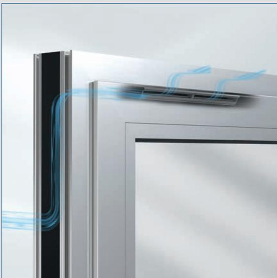
Die frische Luft gelangt kontrolliert von außen durch das geschlossene Fenster in den Raum und verbessert somit die Luftqualität. Durch den labyrinthartigen Weg durch Flügel und Rahmen wird die Luft stetig aufgewärmt, bevor sie in das Rauminnere strömt.
